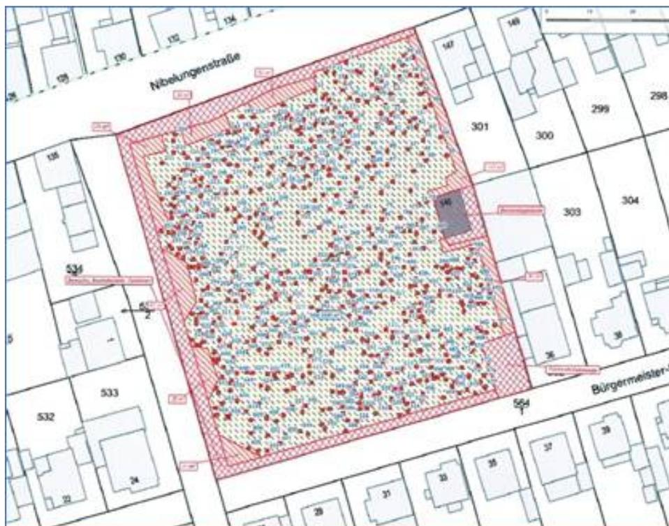
In einem 2. Schritt soll zunächst die grundsätzliche Bodenbeschaffenheit geklärt werden – dies sowohl im Hinblick auf mögliche Altlasten als auch im Hinblick auf die Tragfähigkeit. Hierzu werden 16 Bohrpunkte festgelegt, an denen der Bodengutachter seine Untersuchung vornehmen wird. Hier wird der Kampfmittelräumdienst zunächst die entsprechenden Bereiche freibohren/räumen und für die Bohrungen freigeben. Diese Arbeiten sind für die KW 25 vorgesehen.
